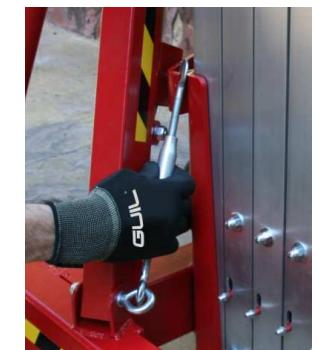
5.- Coloque las horquillas en posición horizontal y fíjelas con los pasadores imantados.
