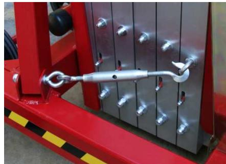
**IMPORTANTE:** Colocar el seguro de los perfiles para evitar su deslizamiento durante el transporte horizontal.
